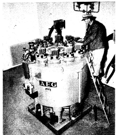
Bild 2. Die Gleichrichter bestehen im wesentlichen aus einem großen Eisengefaß, in das die im Deckel befestigten, mit Kühlrippen versehenen Anoden hineinragen. Durch Pumpen wird das richtige Vakuum im Kessel konstant gehalten.
